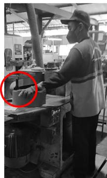
**Gambar 3.** Proyeksi Postur Tubuh Janggal Pergelangan Tangan Menekuk ke Samping pada Proses *Grinding*
